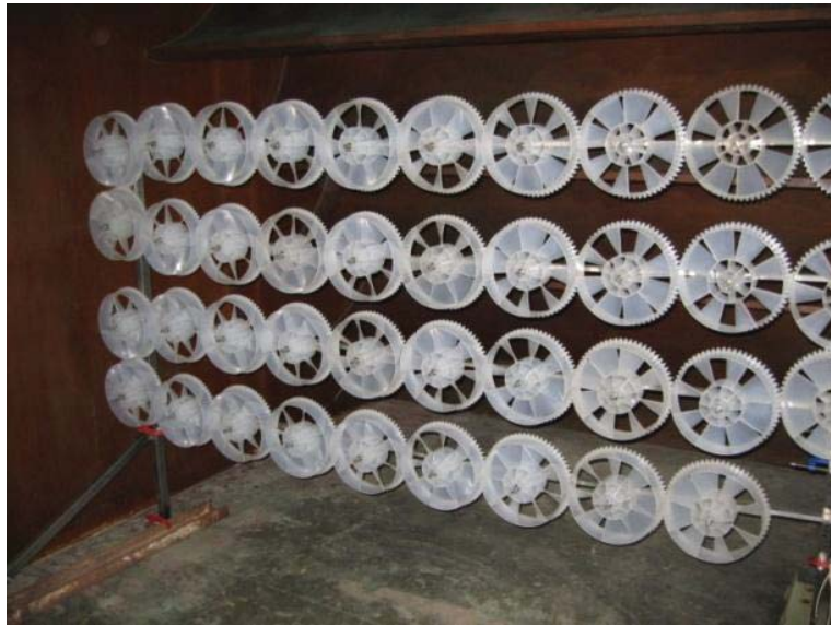
圖 4-7 微型風力發電機系統的風洞測試
